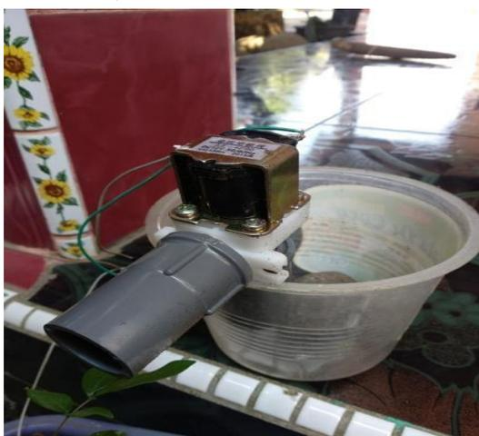
**Gambar 11.** Perangkat Output Valve Solenoid.
