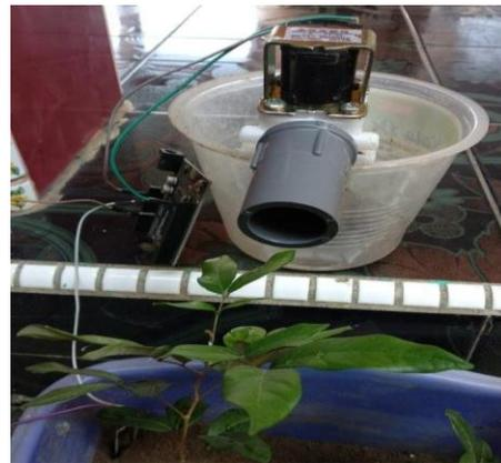
**Gambar 8.** Instalasi Perangkat Input Rain Sensor
